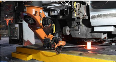
华菱湘钢炼钢区自动加渣机器人
