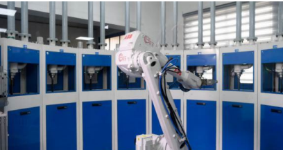
华菱湘钢炼钢区全自动风动送样系统
