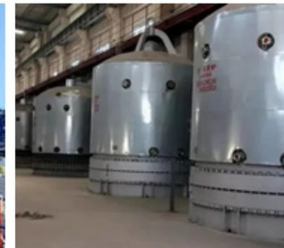
▲ 国内某知名高纯晶硅项目核心装置—世界最大炉型还原炉制造采用公司 4880mm 超宽压力容器钢板
