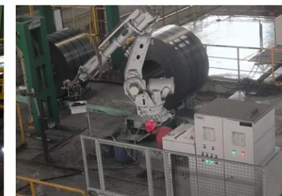
▲ 华菱涟钢2250生产线平整喷号机器人
