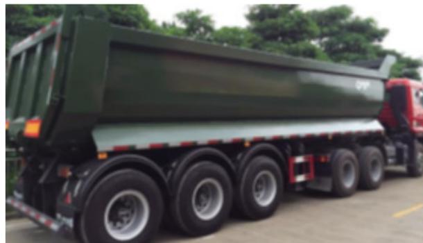
▲ 采用优质调质耐磨钢 NM450 制作的 U 型槽自卸车及采用低屈强比耐磨钢 NM300TP 制作的混凝土搅拌车——采用公司高强韧耐磨钢，极佳韧性耐磨钢的使用，大幅降低了车辆自身重量并延长了使用寿命，广泛用于我国雄安新区建设
