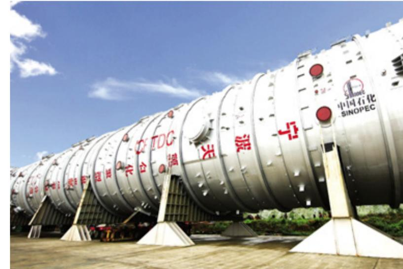
▲ 宁波天翼石化重型设备制造有限公司制造的常压塔—尼日利亚丹格特炼油及石化项目的核心设备，同类装置中设备规格世界最大，采用公司压力容器用钢
